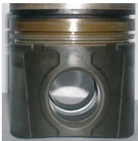
Алюминиевый поршень с кольцевыми канавками MWM TCG 201
