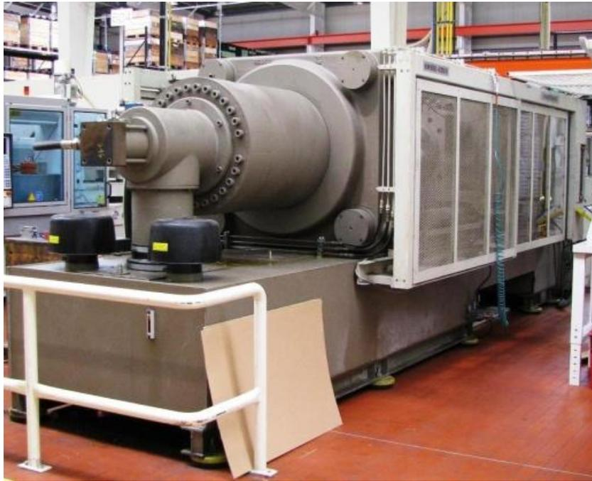
*С февраля 2009 года этот термопластавтомат с усилием смыкания 6500 кН, находящийся на предприятии, снабжающем производителей автомобилей, работает на гидравлическом масле HV Eco Fluid и благодаря этому потребляет почти на 5 % меньше энергии. Объем масла гидравлической системы — примерно 1500 литров.*
